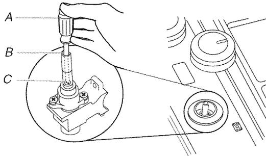
A. Tournevis à lame plate de  $\frac{3}{32}$ " (n° 0 [2,0 mm])
