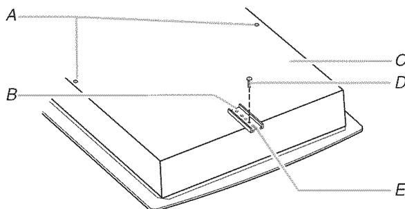
A. Trous de vis d'attache pour emplacement facultatif à l'avant et à l'arrière.
