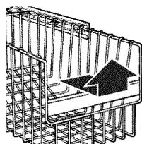
3. Replacer le panier en le plaçant sur les glissières sur la paroi latérale. Soulever légèrement le devant du panier en le poussant au-delà des butées de la glissière et glisser le panier jusqu'au fond.
