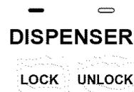
**REMARQUE :** La caractéristique de verrouillage ne discontinuera pas le courant électrique à l'appareil, à la machine à glaçons ou à la lumière du distributeur. Elle sert simplement à désactiver les leviers du distributeur.
