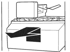
4. Replacer le bac à glaçons en le poussant complètement sinon le distributeur ne fonctionnera pas. Appuyer sur le bras en broche pour l'abaisser à la position ON pour remettre la production de glaçons en marche. S'assurer que la porte est bien fermée.
