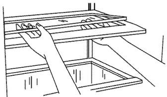
3. Replacer le cadre du couvercle du tiroir à viande dans les supports sur les parois latérales du réfrigérateur et abaisser le devant du cadre du couvercle en place.
