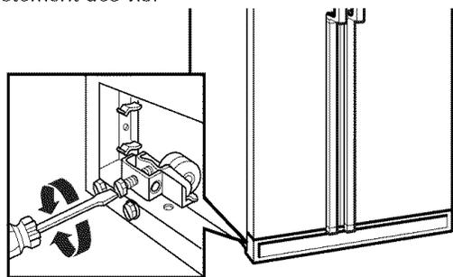
5. Ouvrir les deux portes de nouveau et vérifier pour s'assurer qu'elles se ferment aussi facilement que vous le désirez. Sinon, incliner le réfrigérateur un peu plus vers l'arrière en tournant les deux vis de nivellement vers la droite. Plusieurs tours peuvent être nécessaires et vous devez tourner les deux vis de nivellement d'un espace égal.
