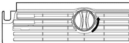
2. Retirer le couvercle de la vieille cartouche de filtre en le glissant hors du bout de la cartouche. Le couvercle glissera vers la gauche ou vers la droite. **NE PAS JETER LE COUVERCLE.**
