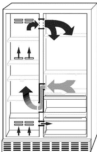
**Ne pas obstruer l'une ou l'autre de ces ouvertures d'aération** avec des aliments tels que boissons gazeuses, céréales, pain, etc. Si les ouvertures d'aération sont obstruées, le débit d'air sera bloqué et le réglage de la température ne fonctionnera pas bien.
