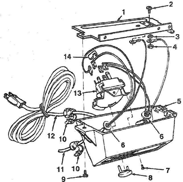
**FIGURE 6 - ON/OFF POWER OUTLET**
