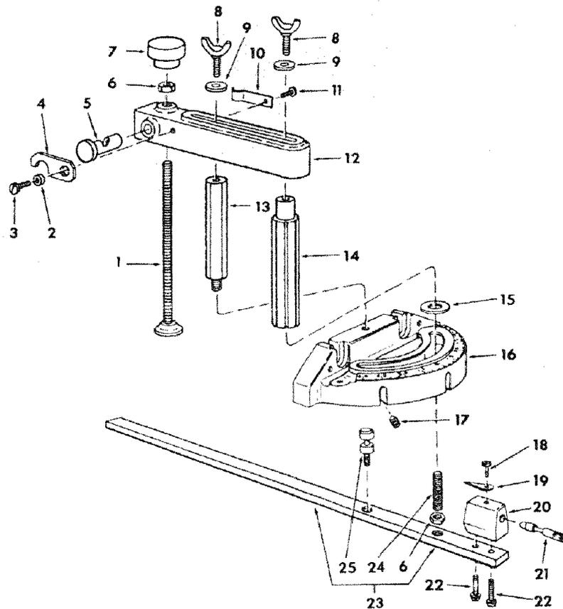
**FIGURE 4 - MITER GAUGE/HOLD DOWN ASSEMBLY 62776**
