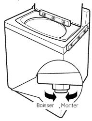
Si la laveuse n'est pas de niveau, réglez les pattes de nivellement avant. Tournez-les dans le sens horaire pour monter et dans le sens antihoraire pour baisser.
