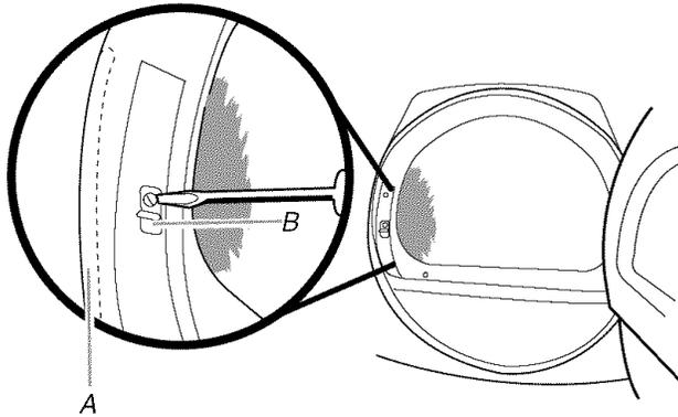
A. Tringle des pitons d'obturation des trous
