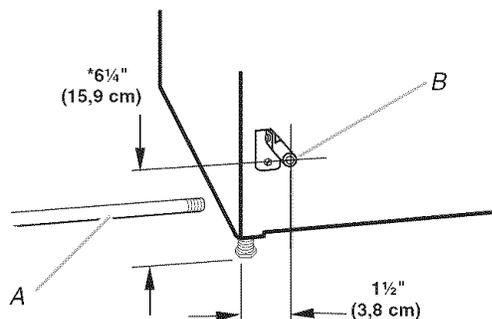
A. Canalisation d'arrivée de gaz NPT de  $\frac{1}{2}$ "
