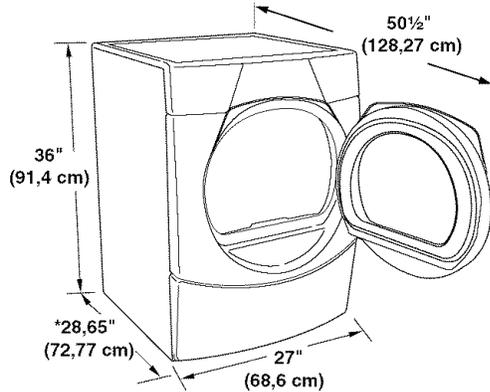
\*La plupart des installations requièrent un espace minimum de 5" (12,7 cm) derrière la sècheuse pour le conduit d'évacuation avec coude. Voir "Exigences concernant l'évacuation".
