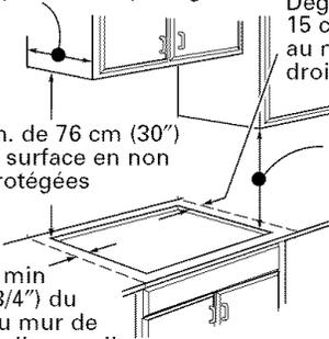
**REMARQUE :** tous les modèles de surface à cuisson au gaz requièrent un dégagement de 1,1 cm (7/16 po) sous la hauteur de la surface pour la matière combustible.
