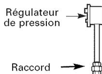
Pour réduire la possibilité de fuites de gaz, posez un ruban de téflon ou mettez de la graisse pour filetage approuvée pour le gaz naturel ou butane sur tous les raccords filetés.
