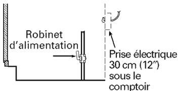
Montez le robinet d'alimentation manuel sur le tuyau de gaz à un emplacement facile à atteindre en dehors de la table de cuisson. Assurez-vous de savoir où et comment couper l'alimentation de gaz à la table de cuisson. Montez la prise électrique 30 cm (12") au-dessous du comptoir.
