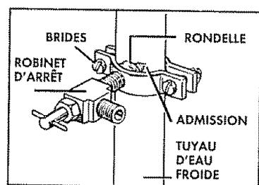
Serrez les vis de la bride soigneusement et régulièrement afin que la rondelle crée un joint étanche. Évitez de serrer trop fort, car vous pourriez écraser les tuyaux en cuivre, particulièrement s'il s'agit de tuyaux de cuivre mou. Vous êtes maintenant prêt à joindre les tuyaux en cuivre.
