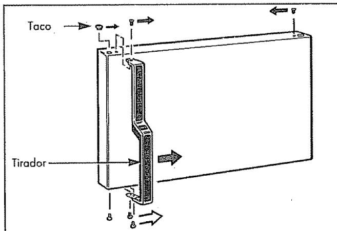
(a) Saque el tornillo aguantando el tirador en la parte superior de la puerta.
