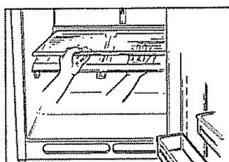
**4. Déposez le cadre du bac.** (Déposez toujours le couvercle en verre avant de sortir le cadre du bac.)
