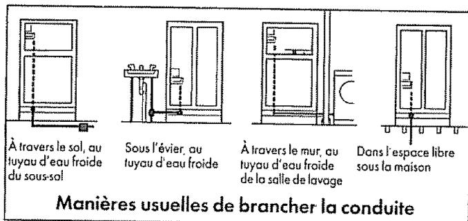
Vous aurez besoin d'un robinet d'arrêt, de deux écrous de compression de 1/4" (diam. ext.), deux manchons de compression et une longueur suffisante de tuyau en cuivre de 1/4" (diam. ext.) pour relier votre réfrigérateur à la conduite d'eau. (Votre magasin Sears ou Bureau de ventes des catalogues a un ensemble disponible avec un robinet d'arrêt à brides et tuyau en cuivre. Avant de l'acheter, assurez-vous qu'un robinet d'arrêt à brides est conforme au code de plomberie local.)
