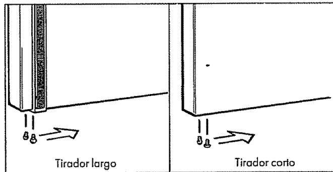
(a) Transfiera los dos tornillos del extremo izquierdo de la parte inferior de la puerta a la parte opuesta. (Espere hasta que el tirador se mueva antes de volver a instalar el tornillo delantero.)
