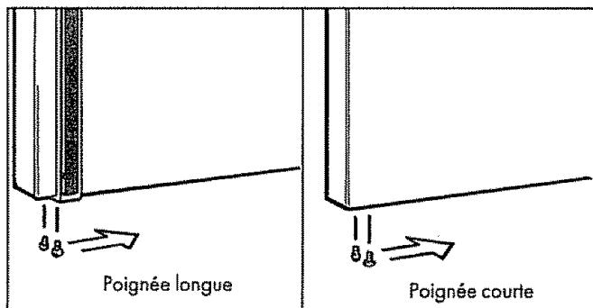
**(a)** Transférez les deux vis, en bas à gauche de la porte, du côté opposé. (Attendez d'avoir déplacé la poignée avant de reposer la vis avant.)
