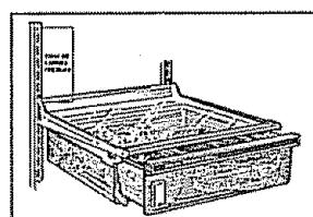
**La palanca de control del regulador de temperatura variable** le permite regular la cantidad de aire frío alrededor de la gaveta.
