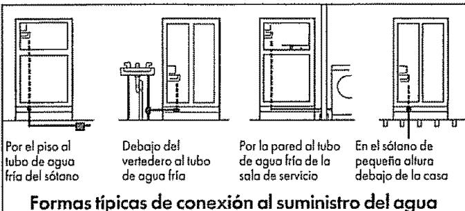
Se necesitarán una llave de paso, dos tuercas de compresión con diámetro exterior de  $1/4"$ , dos férulas de compresión y bastante tubo de cobre de  $1/4"$  (diá. ext.) para conectar el refrigerador al suministro de agua (Su tienda de Sears o su Oficina de venta de catálogos tiene un juego disponible con una llave de paso de tipo campana y tubo de cobre. Antes de comprarlo, asegúrese de que la llave de paso de tipo campana se ajuste a las normas vigentes en materia de plomería.)
