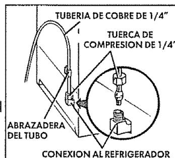
8. ABRA la llave de paso. APRIETE TODAS LAS CONEXIONES O TUERCAS QUE TENGAN FUGAS DE AGUA.
