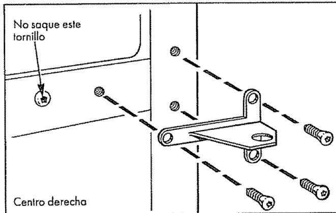
(a) Saque el soporte de la bisagra de la parte central del compartimiento sacando los tres tornillos más exteriores. **NOTA:** Guarde estos tornillos con el soporte de la bisagra. Estos tornillos son más largos y se usarán al instalar la bisagra del otro lado.
