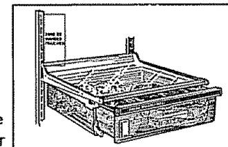
Lorsque les crochets du bac à viande sont insérés dans l'une des six fentes du haut de la crémaillère gauche et que le levier est réglé en position COLDEST (le plus froid), l'air du congélateur circule autour du bac pour le garder très froid.
