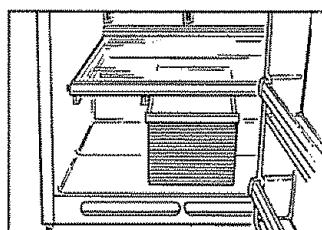
**3. Saque la cubierta de cristal.** Ponga la mano por dentro, empuje la parte de delante de la cubierta de cristal hacia arriba y, al mismo tiempo, estírela hacia delante tanto como pueda. Inclínela y sáquela.
