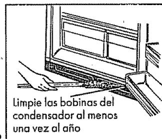
Limpie las bobinas del condensador al menos una vez al año
