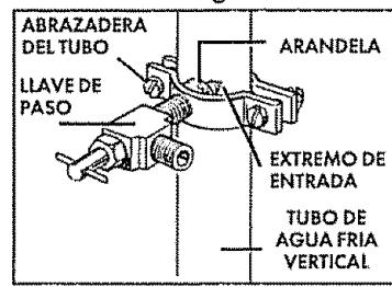
Apriete bien la tuerca de presión. Apriete bien e igualmente los tornillos de la abrazadera del tubo para que la arandela haga una conexión hermética. No apriete demasiado pues podría quebrar el tubo de cobre, especialmente si se usa el tubo de cobre blando. Ahora se puede conectar el tubo de cobre.
