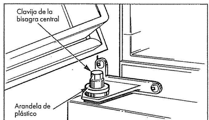
(a) Coloque el encaje de la puerta del congelador en la clavija de la bisagra central. Asegúrese que la arandela esté en su lugar.
