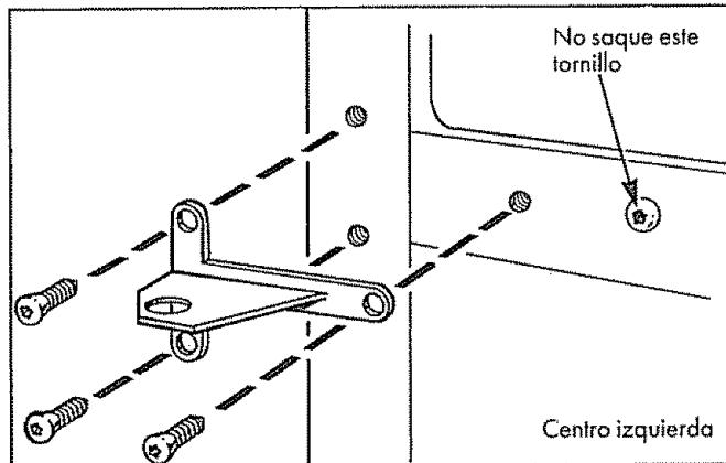
(c) Ponga la cabeza del soporte central de la bisagra en los orificios en la parte central izquierda del compartimiento, inserte los tres tornillos que sacó con el soporte central de la bisagra en el Paso (a) y apriételos.
