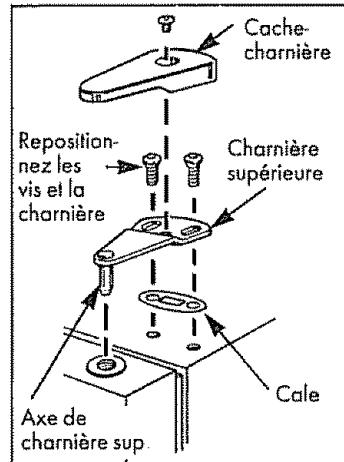
(d) Enlevez le ruban et basculez la porte en l'éloignant de la carrosserie; soulevez-la de façon à dégager sa douille inférieure de l'axe de charnière du support central de la charnière.
