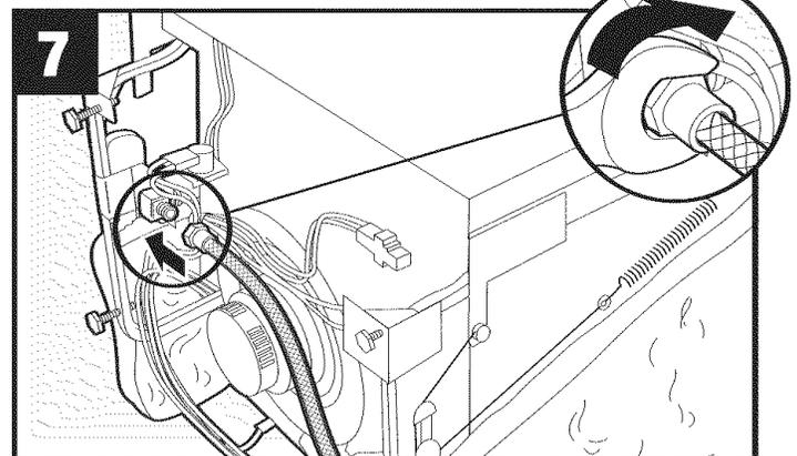
Connect water line if using a flexible braided line. For solid copper line connection refer to step 17./Conecte la tubería de agua usando un conducto tejido flexible. Consulte el paso 17 para la conexión de tuberías de cobre sólido./Raccordez la canalisation d'eau en utilisant un tuyau tressé flexible. Pour le raccordement avec une canalisation en cuivre, reportez-vous à l'étape 17.
