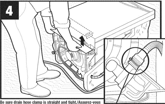
Be sure drain hose clamp is straight and tight./Assurez-vous que le collier de serrage du tuyau de vidange est droit et bien serré./Asegúrese de que la abrazadera de la manguera de drenaje esté derecha y apretada.
