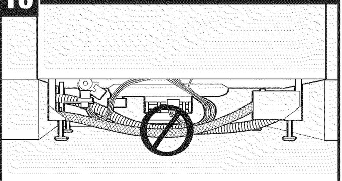
Never route cord or hoses under motor./Nunca coloque el cordón eléctrico ni las mangueras por debajo del motor./Ne jamais faire passer câbles ou tuyaux flexibles sous le moteur.
