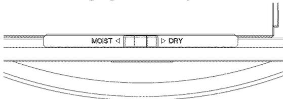
Le curseur de réglage Moist-Dry permet d'ouvrir ou de fermer les ouvertures d'aération dans la porte. Le réglage MOIST (humide) retient l'humidité tandis que le réglage DRY (sec) permet à la vapeur et à l'humidité de s'échapper du tiroir.
