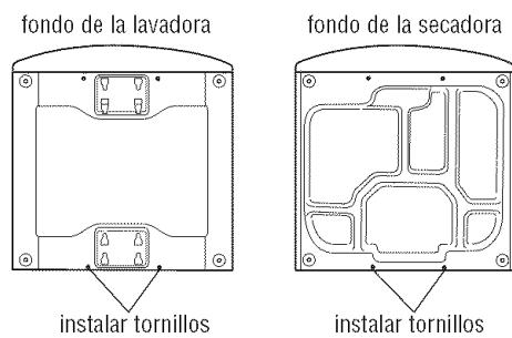
5. Mueva el pedestal acercándolo al fondo de la lavadora/secadora. Deslice las ranuras alargadas del pedestal sobre los dos tornillos parcialmente instalados. Coloque el pedestal hacia el frente de la lavadora/secadora e instale los dos tornillos autorroscantes de cabeza hexagonal restantes. No los apriete completamente.
