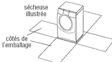
2. Faire basculer l'appareil pour le placer en appui sur la face arrière.
