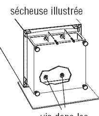
Positionner le piédestal vers l'avant de l'appareil et installer les deux autres vis de tôlerie hexagonales. Ne pas visser complètement.
