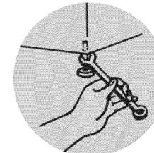
Après avoir établi l'aplomb correct de la laveuse, utiliser une clé plate de 1/4" (14 mm) pour serrer l'écrou de chaque pied contre la caisse de la laveuse.
