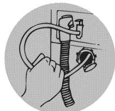
Tirer le cordon d'alimentation à travers l'ouverture et boucher le trou avec le capuchon fourni.
