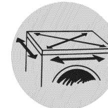
Faire basculer doucement la laveuse d'avant en arrière, transversalement et en diagonale pour vérifier que les quatre pieds sont bien en contact avec le plancher.
