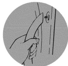
Insérer les 2 vis à travers les trous de la porte. Placer les rondelles de plastique sur les vis. Fixer la poignée en serrant manuellement la vis supérieure puis la vis inférieure. Appuyer la poignée contre la porte. À l'aide d'un tournevis Phillips, serrer les vis.
