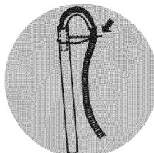
tuyau de rejet à l'égout (doit être à 39" [99 cm] de hauteur minimum),
