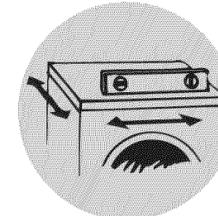
Contrôler l'aplomb de la laveuse, d'un côté à l'autre et de l'avant vers l'arrière.
