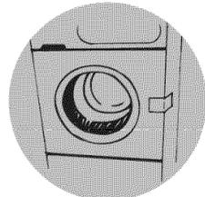
Positionner l'arrière de la laveuse à 3 pi (91,4 cm) de son emplacement final.
