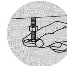
Appuyer sur le panneau avant supérieur pour vérifier que la laveuse repose sur ses pieds arrière. Abaisser le pied avant droit sur le plancher. Manuellement, faire pivoter fermement le pied jusqu'à 1/2 tour supplémentaire.
