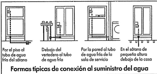
Se necesitarán una llave de paso, dos tuercas de compresión con diámetro exterior de 1/4", dos férulas de compresión y bastante tubo de cobre de 1/4" (diám. ext.) para conectar el refrigerador al suministro de agua. (Su tienda de Sears o su Oficina de venta de catálogos tiene un juego disponible con una llave de paso de tipo campana y tubo de cobre. Antes de comprarlo, asegúrese de que la llave de paso de tipo campana se ajuste a las normas vigentes en materia de plomería.)
