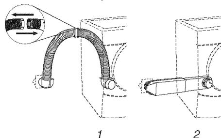
1. Installation au-dessus de la sécheuse (aussi disponible avec un coude décalé)
