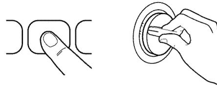
3. Tourner le bouton de commande de programme dans le sens horaire jusqu'au nombre d'heures de mise en marche différée du lave-vaisselle.
