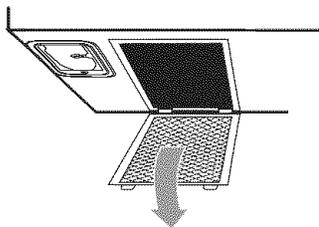
2. Réinstaller les filtres à graisse en insérant l'extrémité sans ongles dans le châssis. Relever l'autre extrémité et la glisser en place.
