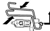
7. Remplacer l'ampoule en la manipulant avec un papier mouchoir ou des gants de coton nettoyés. Ne pas toucher l'ampoule avec les doigts nus.
