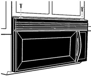
3. Incliner la grille d'évent vers l'avant et la soulever pour la retirer.
