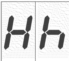
La surface de cuisson est dotée d'un indicateur de surface chaude pour chaque élément. L'indicateur signale les éléments dont la surface est encore chaude.
