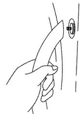
4. Appuyer la poignée contre la porte. À l'aide d'un tournevis Phillips, serrer les vis.
