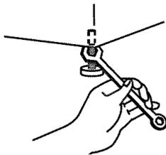
**IMPORTANT :** Les quatre pieds doivent être bien serrés. Si les écrous ne sont pas bloqués contre la caisse de la laveuse, la laveuse peut vibrer.
