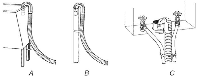
Si les robinets d'eau et le tuyau rigide de rejet à l'égout sont placés en retrait (voir illustration C), introduire l'extrémité en col de cygne du tuyau de vidange dans le tuyau rigide de rejet à l'égout. Attacher fermement les tuyaux d'arrivée d'eau et le tuyau de vidange ensemble, avec l'attache.
