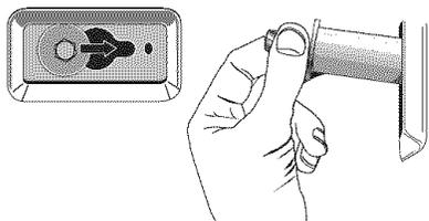
3. Une fois que les 4 boulons ont été retirés, jeter les boulons et les cales d'espacement. Puis tirer le cordon d'alimentation à travers l'ouverture du panneau arrière et obturer le trou avec le bouchon fourni.
