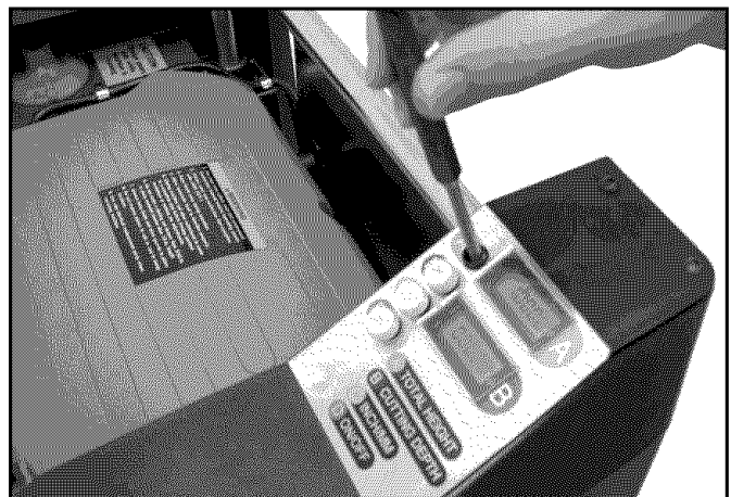
Figura 17 – Calibración del Indicador LCD
