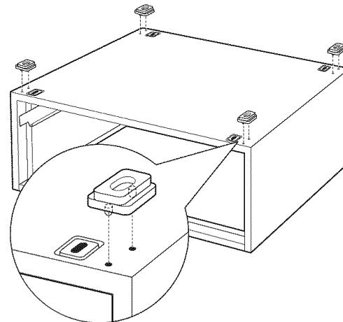
**REMARQUE :** les coussinets de support doivent être installés seulement sur la sécheuse. N'INSTALLEZ PAS CES COUSSINETS SUR LE SOCLE DE LA LAVEUSE.
