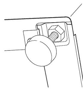
**NOTA:** para minimizar la vibración, las tuercas de seguridad deben estar apretadas.
