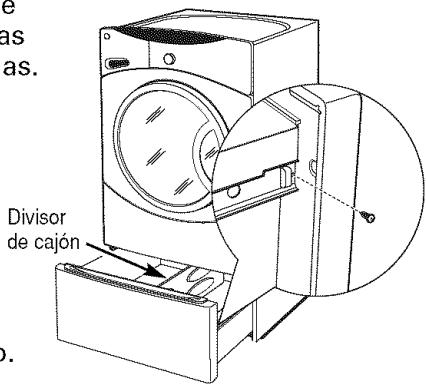
**C** Vuelva a instalar los tornillos originales en cada una de las correderas del cajón. Apriete ambos tornillos.
