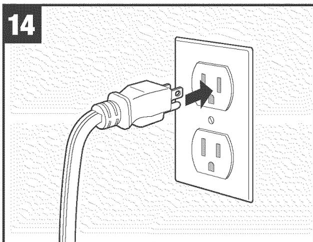
3-Pronged grounded outlet; 120V 60Hz, 15 amp rating required./Une prise 120 V, 60 Hz, 15 A à 3 alvéoles, mise à la terre, est nécessaire./Se requiere un tomacorriente de 120 V 60 Hz, 15 Amp. de 3 alvéolos, puesto a tierra.
