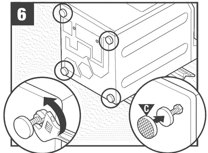
Loosen (4) lock nuts on adjustable legs, then add (4) rubber feet./Desserrez les (4) contre-écrous des pieds de mise à niveau, puis installez les (4) embouts en caoutchouc./Afloje las (4) tuercas de bloqueo de las patas ajustables e instale (4) patas de goma.
