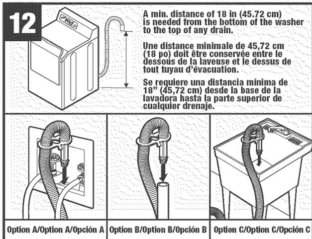
Fully insert cuff into drain pipe, approximately 3 in., or drape over sink rim./ Insérez complètement l'extrémité du tuyau d'évacuation dans le tuyau vertical, d'environ 7,6 cm, ou placez-le sur le bord de l'évier./Instale completamente el extremo en la tubería de desagüe, aproximadamente 7,6 cm, o colóquela sobre el borde del fregadero.
