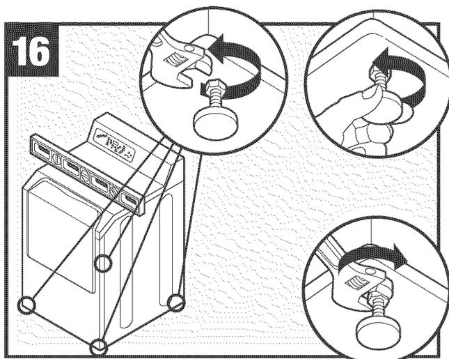
Adjust legs until washer is level side-to-side and front-to-back. Then lock the nut to the machine base./Réglez les pieds de la laveuse jusqu'à ce qu'elle soit mise à niveau. Ensuite, verrouillez l'écrou à la base de la machine./Ajuste las patas hasta que la lavadora esté nivelada de lado a lado y de adelante hacia atrás. Luego bloquea la tuerca en la base de la lavadora.
