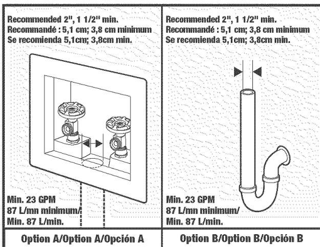
Minimum of 23 gallons per minute; recommended 2" diameter standpipe/ Minimum de 87 L par minute; tuyau vertical d'évacuation – diamètre recommandé : 5,1 cm/Mínimo de 87L por minuto; se recomienda un tubo vertical de evacuación de 5,1cm de diámetro
