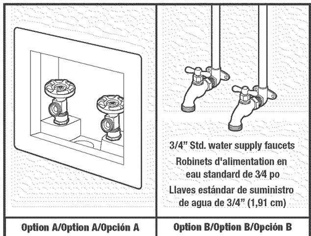
Minimum 25-120 psi water pressure at machine/Pression minimale à l'arrivée d'eau de la laveuse : 172-862 kPa/Presión mínima de entrada del agua a la lavadora: 172-862 KPa.
