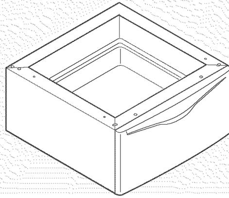
Attach riser/pedestal BEFORE removing straps on washer in step 8. Refer to riser installation instructions for further information./Fixez le support/socle AVANT d'enlever les sangles à l'étape 8. Pour de plus amples renseignements, reportez-vous aux instructions d'installation du socle./Instale el elevador/pedestal ANTES de retirar los amarres de la lavadora en el paso 8. Consulte las instrucciones de instalación para mayor información.
