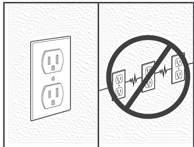
Washer outlet should be on its own circuit./La prise de la laveuse doit être sur un circuit indépendant./El tomacorriente de la lavadora debe estar en un circuito independiente.
