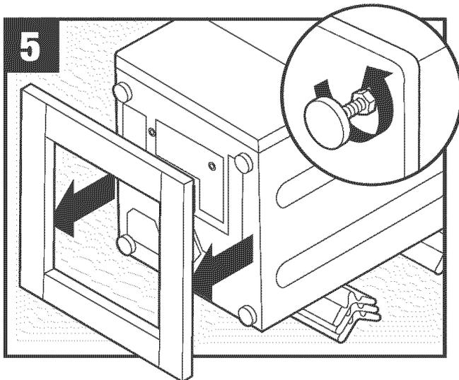
Remove crate bottom and loosen (4) height adjustable legs./Enlevez le cadre et desserrez les (4) pieds de mise à niveau ajustables./Retire la base de la caja y afloje las (4) patas ajustables.
