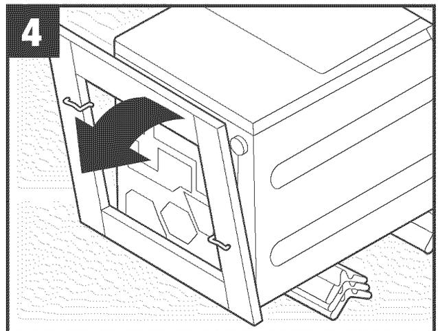
Pry away crate retaining clips./Dégagez les attaches de retenue du cadre de déménagement./Extraiga los sujetadores de retención de la caja.
