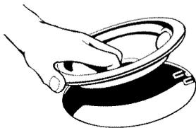
2. Tenir l'élément en spirale le plus possible à niveau et pousser doucement la fiche de l'élément en spirale dans la prise.
