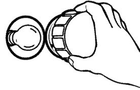
3. Tourner l'ampoule dans le sens inverse des aiguilles d'une montre et l'enlever de la douille.
