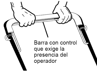
CONTROL DE LA IMPULSIÓN ENGRANCHAR
