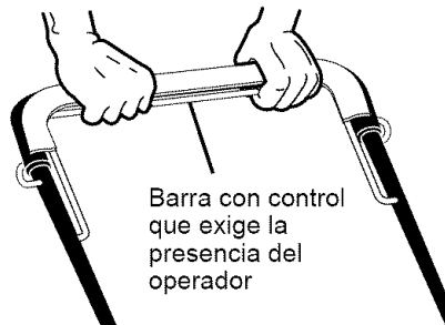
CONTROL DE LA IMPULSIÓN ENGRANCHAR
