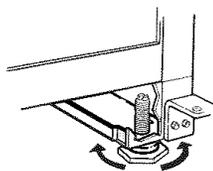
5. Pousser vers le haut sur la partie arrière de la machine à glaçons pour repérer les pieds de nivellement qui se trouvent sur le fond arrière de la machine à glaçons.
