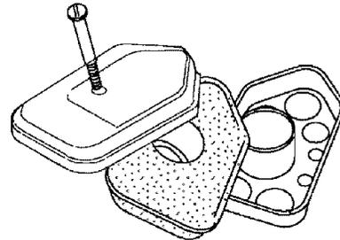
2. Enlevez l'ensemble filtre à air avec soin de manière à éviter la chute de débris dans le carburateur.
