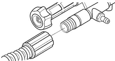
3. Avant de brancher votre tuyau d'arrosage à la prise d'eau, inspectez la filtre intégré. Nettoyez la filtre intégré si elle contient des débris, remplacez-la si elle est endommagée. Si la crépine est endommagée, consultez la section "Entretien du joint torique". **NE VOUS SERVEZ PAS DU NETTOYEUR À PRESSION SI LA FILTRE INTÉGRÉ EST ENDOMMAGÉE.**
