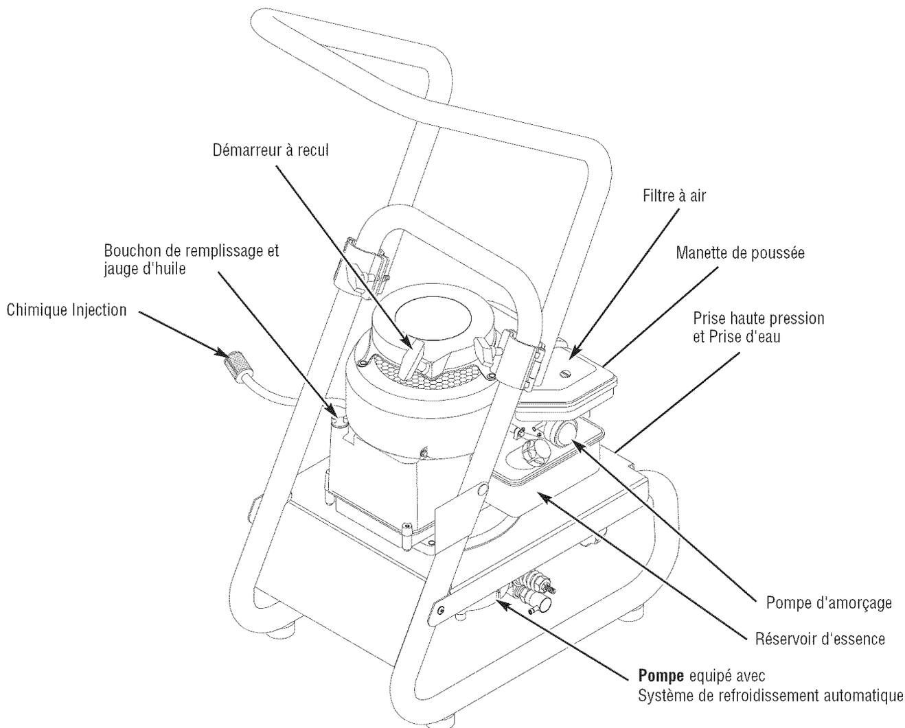
**Bouchon de remplissage et jauge d'huile** — Vérifiez le niveau d'huile et remplissez le moteur d'huile ici. Consultez la page 48 au sujet des recommandations relatives à l'huile et des directives de remplissage.
