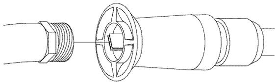
8. Réinstallez le gicleur et le filtre intégré dans la rallonge. NE serrez PAS trop le gicleur avec la clé hexagonale.
