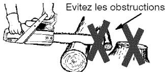
Dégager l'endroit du travail
