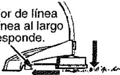
Toque el cabezal siempre contra el suelo donde haya césped. El contacto contra las superficies tales como el cemento o asfalto causará desgaste excesivo del cabezal.
