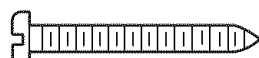
Tornillo para la consola de control de 6AB por 1-1/4 pulg. (instalación estándar)
