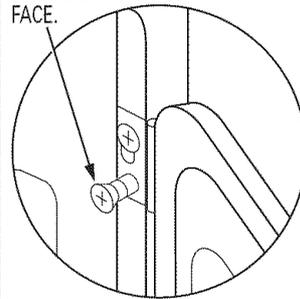
LOOSEN THE TOP SCREWS FROM EACH HINGE ON THE DRYER FACE HALF WAY.
