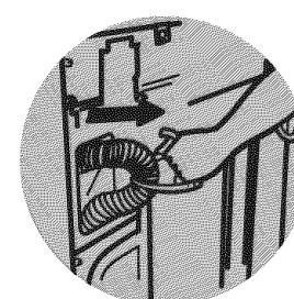
Localiser l'attache de fixation pour retirer le tuyau d'évacuation de la laveuse. Dégager complètement le tuyau de vidange de la laveuse en saisissant d'abord l'attache de fixation.
