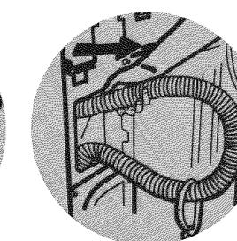
Tirer sur le tuyau d'évacuation pour le sortir de la laveuse à partir de la partie supérieure du tuyau. Continuer à tirer sur le tuyau jusqu'à ce que l'extrémité se dégage.
