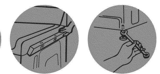
Si elle est d'aplomb, utiliser une clé plate de ¾" ou 14 mm pour serrer l'écrou de blocage à la base de la laveuse.
