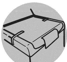
Le couvercle doit être immobilisé avec du ruban adhésif avant le déplacement de la laveuse.
