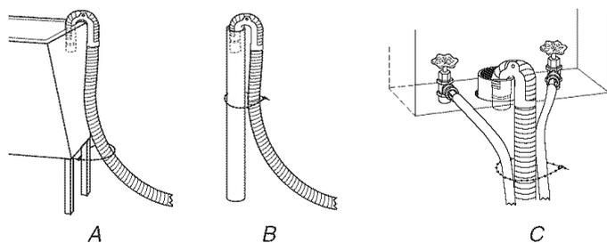
4. Si les robinets d'eau et le tuyau rigide de rejet à l'égout sont placés en retrait, introduire l'extrémité en crochet du tuyau de vidange dans le tuyau rigide de rejet à l'égout - voir l'illustration. Voir l'illustration C.
