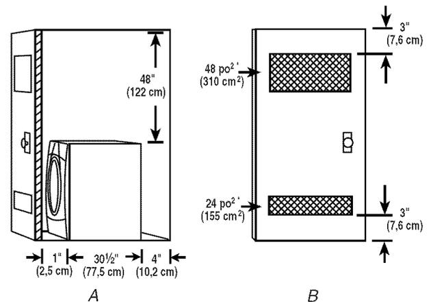
**Installation dans un encastrement ou placard - laveuse sur piédestal**
