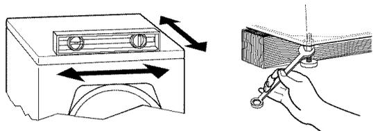
Si la laveuse est placée contre un mur, on doit l'écartier légèrement du mur avant de l'incliner vers l'arrière. Si la laveuse n'est pas d'aplomb, soulever l'avant de la laveuse avec une cale de bois et ajuster la position des pieds selon le besoin; soulever ensuite l'arrière de la laveuse et ajuster la longueur des pieds selon le besoin. Répéter ces opérations jusqu'à l'obtention d'un aplomb correct de la laveuse.
