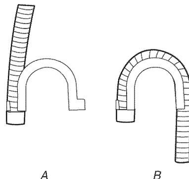
A. Emboîter une extrémité ou l'autre de la bride de retenue pour tuyau de vidange sur le tuyau de vidange, au point de commencement des ondulations.
