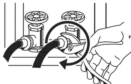
**REMARQUE :** Ne pas serrer excessivement ou utiliser du ruban adhésif ou un cafeutranteur sur la valve. Les valves risquent d'être endommagées.
