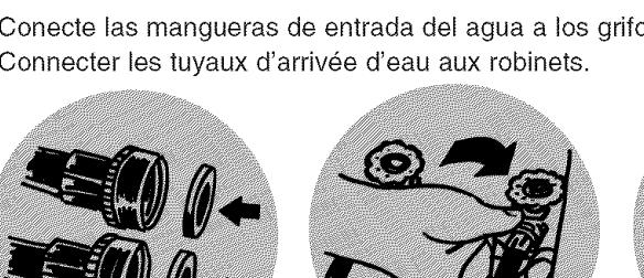
Conecte las mangueras de entrada del agua a los grifos.
