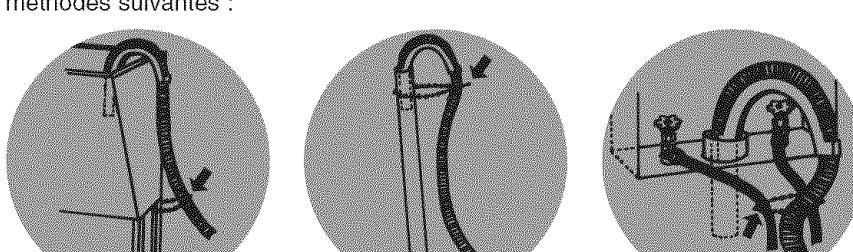
Asegure la manguera de desagüe con el fleje de atadura rebordeado, de una de las maneras siguientes:
