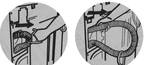
Ubique la atadura para sacar la manguera de desagüe de la lavadora. Jale la manguera de desagüe fuera de la lavadora agarrando primero la atadura.
