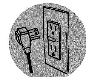
Conecte a un contacto de pared de conexión a tierra de 3 terminales. Verifique si hay fugas alrededor de los grifos, de las mangueras de entrada y de la manguera de desagüe.
