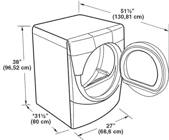
\*La plupart des installations requièrent un espace minimum de 5 1/2" (14 cm) derrière la sècheuse pour le conduit d'évacuation avec coude. Voir "Exigences concernant l'évacuation".
