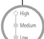
Cette laveuse sélectionne automatiquement la vitesse d'essorage en fonction du programme sélectionné. Les vitesses préréglées peuvent être modifiées pour la plupart des programmes.
