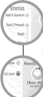
Cette laveuse permet d'ajouter des vêtements à la charge tant que le témoin Add A Garment est allumé. Appuyer une fois sur STOP (arrêt) pour mettre le programme en pause. Lorsque le témoin Lid Lock (couvercle verrouillé) est allumé, le couvercle de la laveuse est verrouillé. Lorsque le témoin Lid Lock s'éteint, ouvrir le couvercle et ajouter des vêtements.
