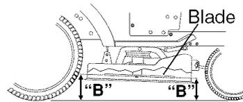
**BOTH FRONT PLATE LINKS MUST BE EQUAL IN LENGTH**
