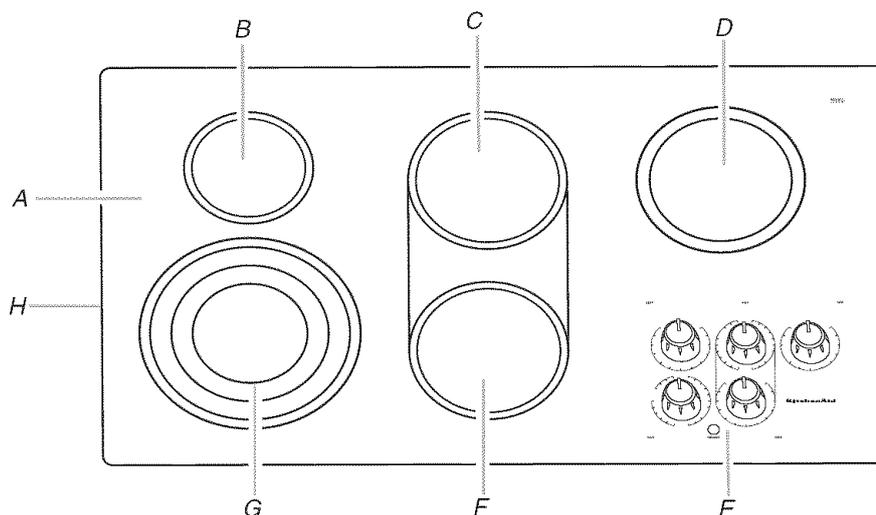
A. Table de cuisson en vitrocéramique (les modèles en acier inoxydable comportent une garniture métallique)
