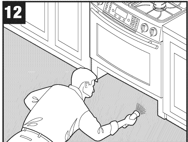
12 Check leg position in ANTI-TIP bracket./Vérifiez la position du pied dans la bride ANTI-BASCULEMENT./Verifique la posición de la pata en el soporte ANTIVUELCO.
