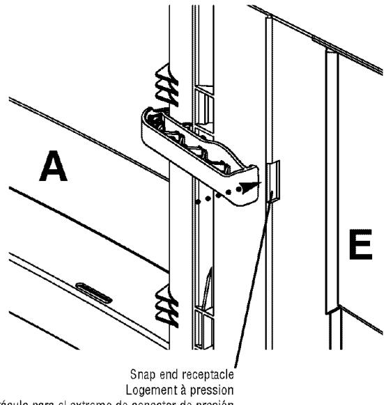
21. Tout en veillant à ce que la languette du crochet de porte demeure en place, continuez à guider le crochet de porte (P) le long de la fente destinée au crochet afin que l'extrémité à pression du crochet de porte se trouve au-dessus de l'embout à pression correspondant du panneau latéral (E).
