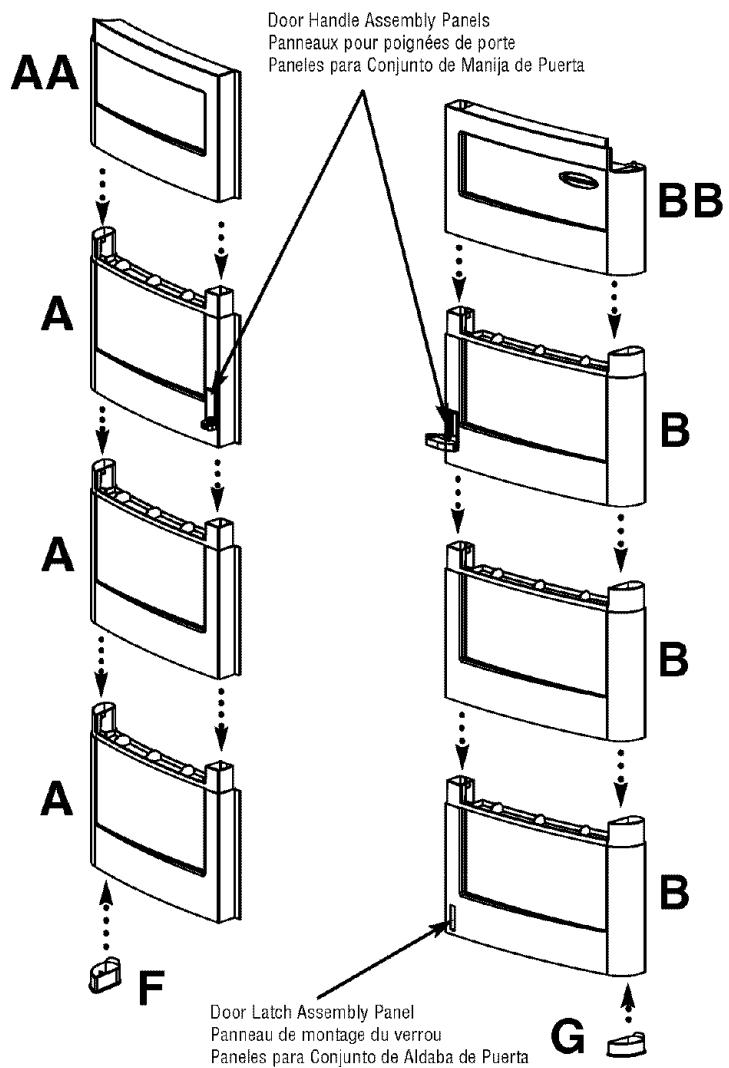
5. Arme la Puerta Derecha, colocando uno sobre otro dos Paneles Inferiores de Puerta (B y B) y presionando hasta que estas dos piezas encajen juntas.
