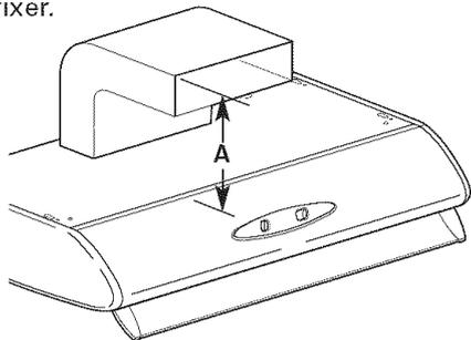
Mesurer la distance A et reporter cette dimension sur l'axe central du soffite. Tracer/découper l'ouverture de 8,3 x 25,4 cm (3 1/4 x 10 po) dans le soffite.
