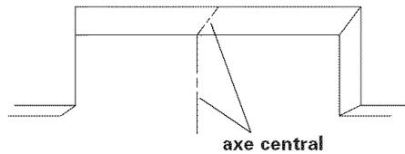
**5.** Tracer les lignes correspondant à l'axe central sur le mur arrière et sur le fond du placard mural supérieur.
