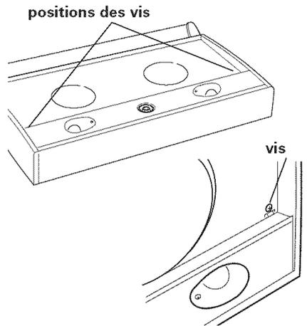
**14.** Ôter les deux vis des onglets du diffuseur de lumière. Sur la surface du diffuseur de lumière, directement derrière les onglets, pousser vers l'arrière de la hotte pour dégager les onglets des fentes. Enlever le diffuseur de lumière; conserver le diffuseur et les vis à part.
