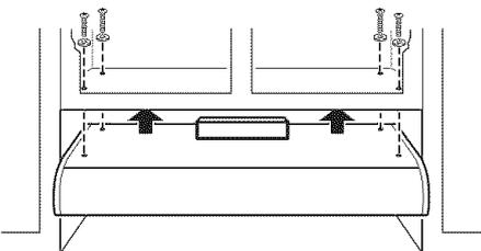
**19.** Soulever la hotte jusqu'à sa position d'installation, tout en introduisant le câble d'alimentation
