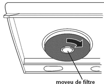
**23.** Installations d'une hotte pour recyclage (sans décharge) : Installer les filtres à charbon. Placer le filtre sur son moyeu dans chaque ouverture de ventilateur, pousser vers le haut et tourner dans le sens horaire pour bloquer le filtre en place.
