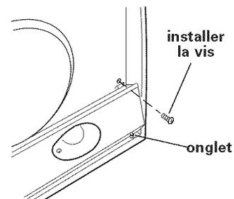
**22.** Réinstaller le diffuseur de lumière. Insérer les onglets du diffuseur dans leur logement. Pousser à l'arrière du panneau diffuseur de lumière et insérer les petits onglets dans leur logement à l'arrière de la hotte. Réinstaller les deux vis et bien serrer.
