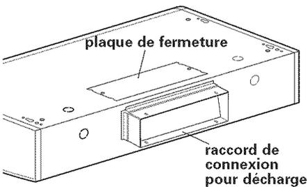
**Pour la décharge de l'air à travers le mur,** ôter la plaque de fermeture à l'arrière de la hotte et le connecteur de décharge fixé au sommet de la hotte. Réinstaller le connecteur de décharge à l'arrière de la hotte, et réinstaller la plaque de fermeture au sommet de la hotte.
