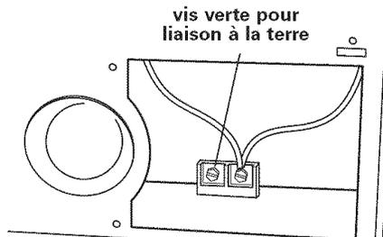
**21.** Raccorder les conducteurs du câble d'alimentation de la hotte aux conducteurs de même couleur du circuit électrique, avec des connecteurs vissables (blanc-blanc et noir-noir).
