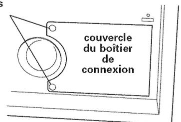
**15.** Ôter les deux vis du couvercle du boîtier de connexion (angle arrière/à droite) et ôter le couvercle. Installer un serre-câble (homologation U.L. ou CSA) dans le trou de passage de câble.
