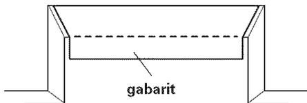
**6.** Aligner la ligne de l'axe central du gabarit avec les lignes tracées sur le mur arrière et sur le fond du placard mural supérieur. Fixer le gabarit en place avec du ruban adhésif. Marquer la position des quatre trous utilisés pour la fixation de la hotte sur le placard mural supérieur.
