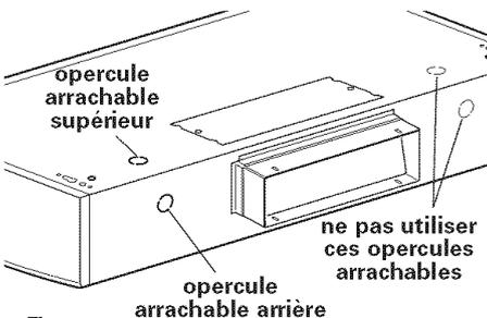
**4.** Ôter l'opercule arrachable du trou (au sommet ou à l'arrière) qui doit être utilisé pour le passage du câble.
