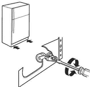
5. Ouvrir les deux portes de nouveau et s'assurer qu'elles se ferment aussi facilement que vous le désirez. Sinon, incliner le réfrigérateur un peu plus vers l'arrière en tournant les deux vis de nivellement vers la droite. Plusieurs tours peuvent être nécessaires et vous devez tourner les deux vis de nivellement d'un espace égal.
