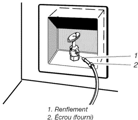
**REMARQUE :** Serrer l'écrou à la main. Ensuite, le serrer avec une clé deux tours de plus. Ne pas serrer excessivement.
