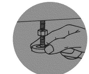
Apóyese sobre el panel delantero superior para asegurarse de que la lavadora esté sobre las patas traseras. Baje la pata delantera derecha hasta el piso. Gire la pata a mano firmemente hasta 1 1/2 giro adicional. Sacuda suavemente la lavadora desde el frente hacia atrás, de lado a lado y diagonalmente para verificar que las cuatro patas estén en contacto firme con el piso.
