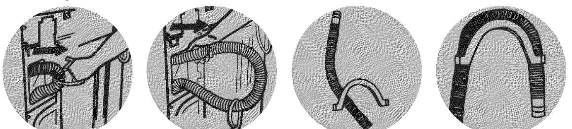
Ubique la atadura para sacar la manguera de desagüe de la lavadora. Jale la manguera de desagüe fuera de la lavadora agarrando primero la atadura.
