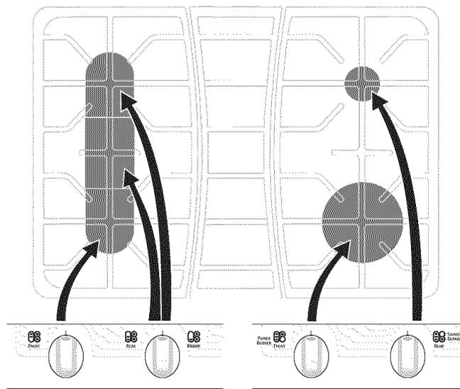
FRONT REAR BRIDGE POWER BURNER FRONT REAR SIMMER BURNER
