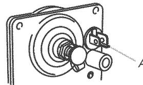
A. Robinet d'arrêt du détendeur
