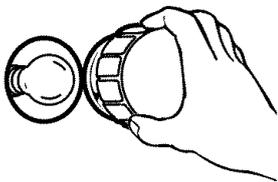
3. Tourner l'ampoule dans le sens antihoraire pour l'enlever de la douille.
