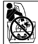
PELIGRO Apague el motor antes de despejar el tubo. Use sólo la herramien- ta de limpieza, no las manos, para despejar el tubo.
