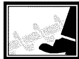
PELIGRO Evite las lesiones que puede causar la barrena rotatoria. Mantenga las manos, los pies y la ropa fuera de su alcance.
