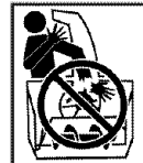
PELIGRO Apague el motor antes de despejar el tubo. Use sólo la herramienta de limpieza, no las manos, para despejar el tubo.
