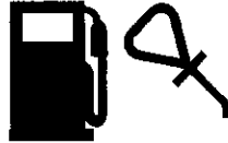
Mezcla de combustible y aceite
