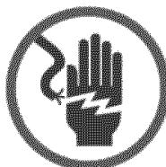
**ATTENTION :** Pour empêcher tout contact accidentel avec les connexions électriques, un lave-vaisselle encastré ne doit pas être branché sur le courant électrique tant qu'il n'est pas complètement encastré et tant que le panneau avant n'a pas été remis en place. Si l'arrière ou un des côtés du lave-vaisselle est exposé, un panneau devra être posé pour fermer cette ouverture. Ne pas respecter cet avertissement risque de causer la mort ou de graves blessures.
