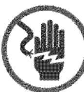
**PRECAUCIÓN:** Para evitar la posibilidad de choque eléctrico, este lavavajillas, al igual que otros aparatos eléctricos, debe ser puesto a tierra en forma adecuada. El instalador tiene la responsabilidad al respecto en el punto de instalación, debiendo tomar en cuenta las condiciones y los requisitos locales.
