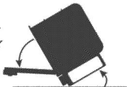
Il faudra peut-être prévoir un point de fixation supplémentaire pour les vis. Dans le cas des comptoirs en granit ou d'un seul bloc, des lattes de bois fixées sous l'ouverture prévue pour le lave-vaisselle pourront être utilisées pour l'immobiliser en place.
