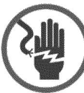
**PRECAUCIÓN:** Para evitar un contacto accidental con las conexiones eléctricas, los modelos de lavavajillas empotrados no deben ser conectados a una fuente de corriente eléctrica, a menos que el lavavajillas esté totalmente encerrado, con los paneles delanteros colocados en su lugar. Si la parte posterior o lateral del lavavajillas queda expuesta, se deberá usar un panel para completar el encerramiento. Si se hace caso omiso de esta advertencia, existe el riesgo de muerte o lesiones graves.
