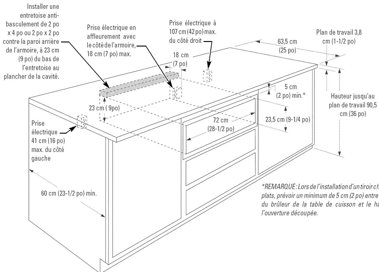
\*REMARQUE: Lors de l'installation d'un tiroir chauffe-plats, prévoir un minimum de 5 cm (2 po) entre le bas du brûleur de la table de cuisson et le haut de l'ouverture découpée.
