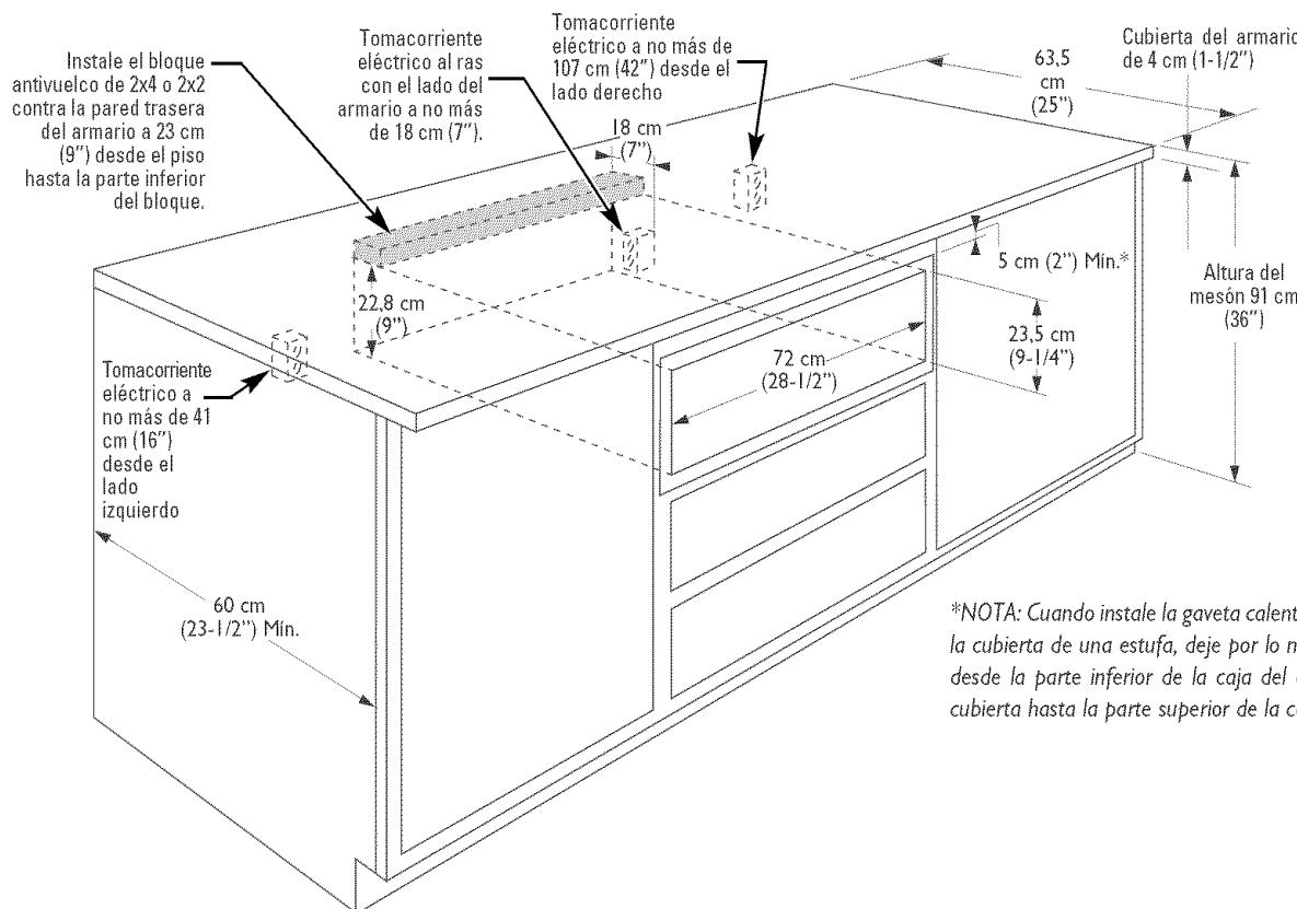
\*NOTA: Cuando instale la gaveta calentadora debajo de la cubierta de una estufa, deje por lo menos 5 cm (2") desde la parte inferior de la caja del quemador de la cubierta hasta la parte superior de la cavidad.
